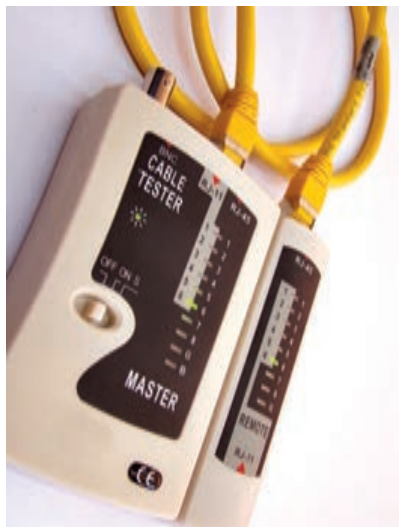
شکل ۲۰- تست کابل شبکه
