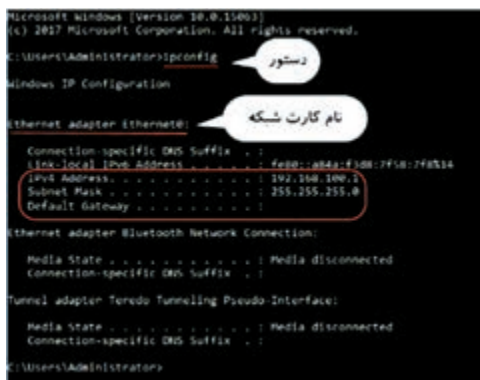
شکل ۲- اجرای دستور ipconfig بدون پارامتر
