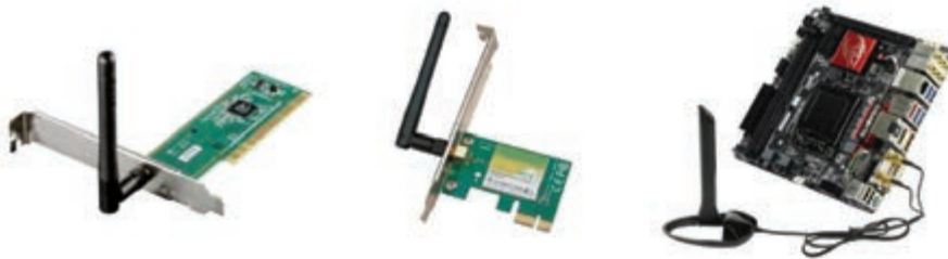
شکل ۵- کارت شبکه بی سیم داخلی
