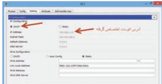
شکل ۳۰- تنظیم آدرس IP سرویس‌گیرنده‌ها در حالت خودکار
