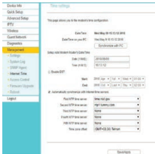
شکل ۶۳- تنظیمات ساعت مودم ADSL
