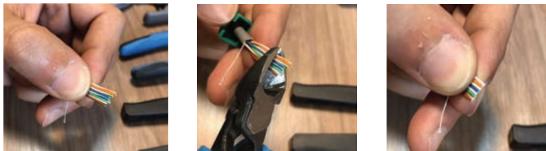
شکل ۲۷- مرتب کردن سیم‌های رنگی مطابق استاندارد
