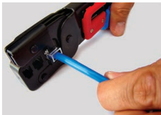
شکل ۲۹- پرس کردن سوکت RJ45
