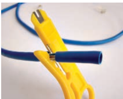
شکل ۲۵- لخت کردن سر کابل
