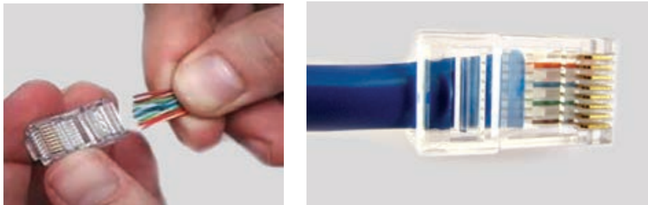
شکل ۲۸- قرار دادن سیم‌ها در سوکت
