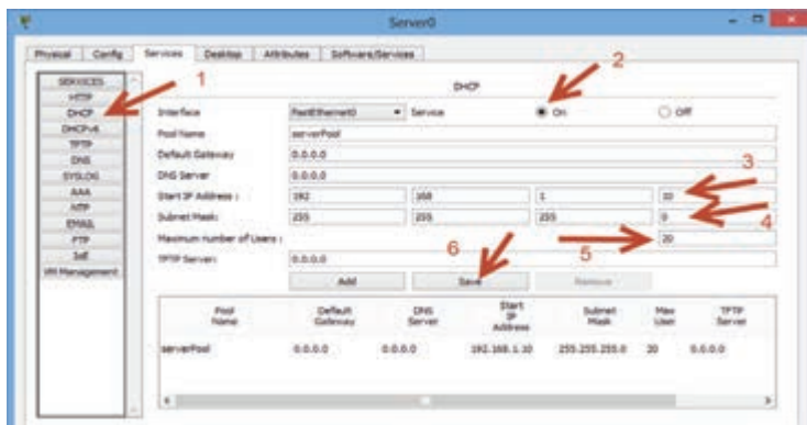
شکل ۲۹- تنظیمات سرویس DHCP روی سرور
