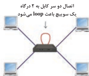
شکل ۵۹- وجود loop در سویچ
