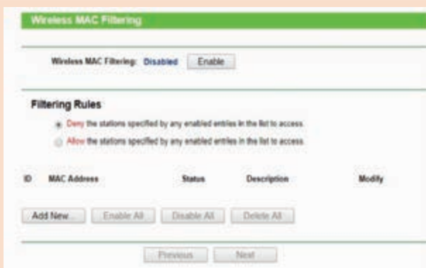
شکل ۳۹- تنظیمات MAC Filtering
