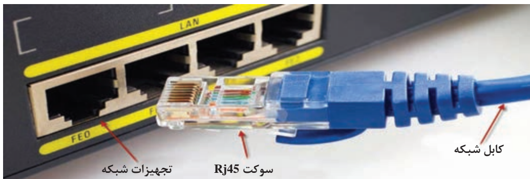
شکل ۶- اتصال سوکت Rj45 به تجهیزات شبکه
