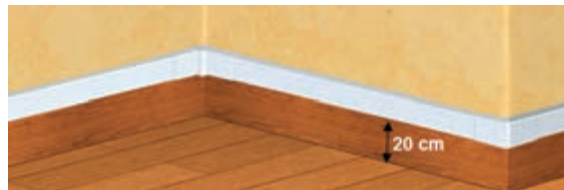
شکل ۵۲ - فاصله داکت یا ترانک از کف
