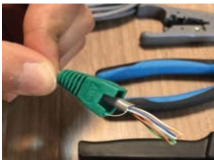
شکل ۲۶- وارد کردن کاور سوکت سر کابل
