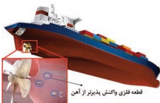
شکل ۱۲. چگونگی حفاظت کاتدی بدنه کشتی
