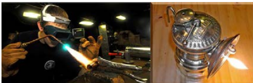
شکل ۷. استفاده از گاز اتین (استیلن) در برشکاری فلزات و لامپ‌های کاربردی.
