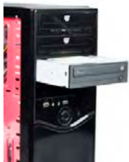
شکل ۵۰- قراردادن دیسک گردان نوری در کیس
