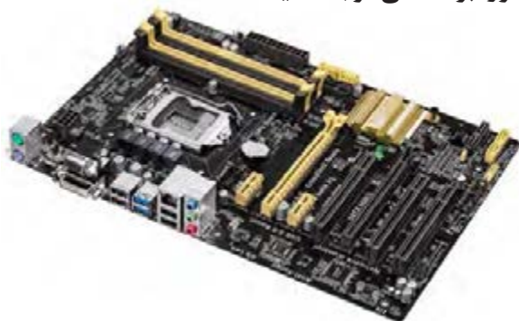
شکل ۸ - برد اصلی با فرم فاکتور ATX
