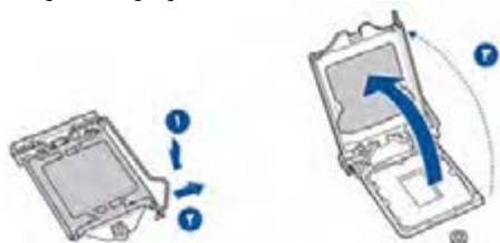
شکل ۳۲- آزاد کردن نگهدارنده سوکت
