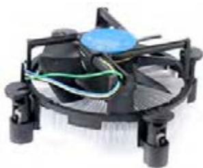
شکل ۳۶ - سیستم خنک‌کننده پردازنده
