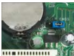
شکل ۱۴- جامپر Clear CMOS
