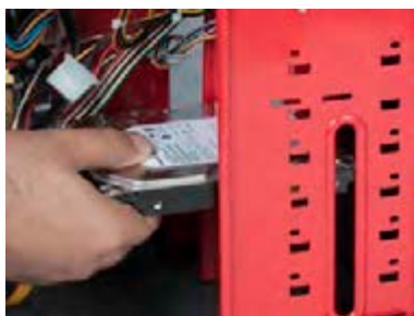
شکل ۴۸- محل نصب دیسک سخت
