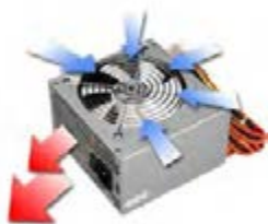
شکل ۲۳- جهت تهویه هوا در منبع تغذیه
