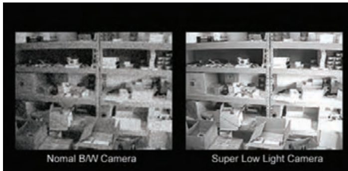
شکل ۱۸- تأثیر مشخصه Minimum Illumination در تصویر
