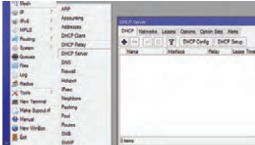
شکل ۳۲- مسیر دسترسی به تنظیمات DHCP Server
