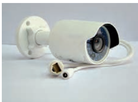
شکل ۱- اجزای دوربین تحت شبکه
